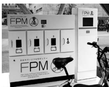
左のボックスではバッテリーを充電し、自転車のカギを収納。右のボックスでは自転車ドックを開閉する
