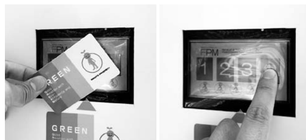
専用ICカードでバッテリーボックスの開閉を行う仕組み
